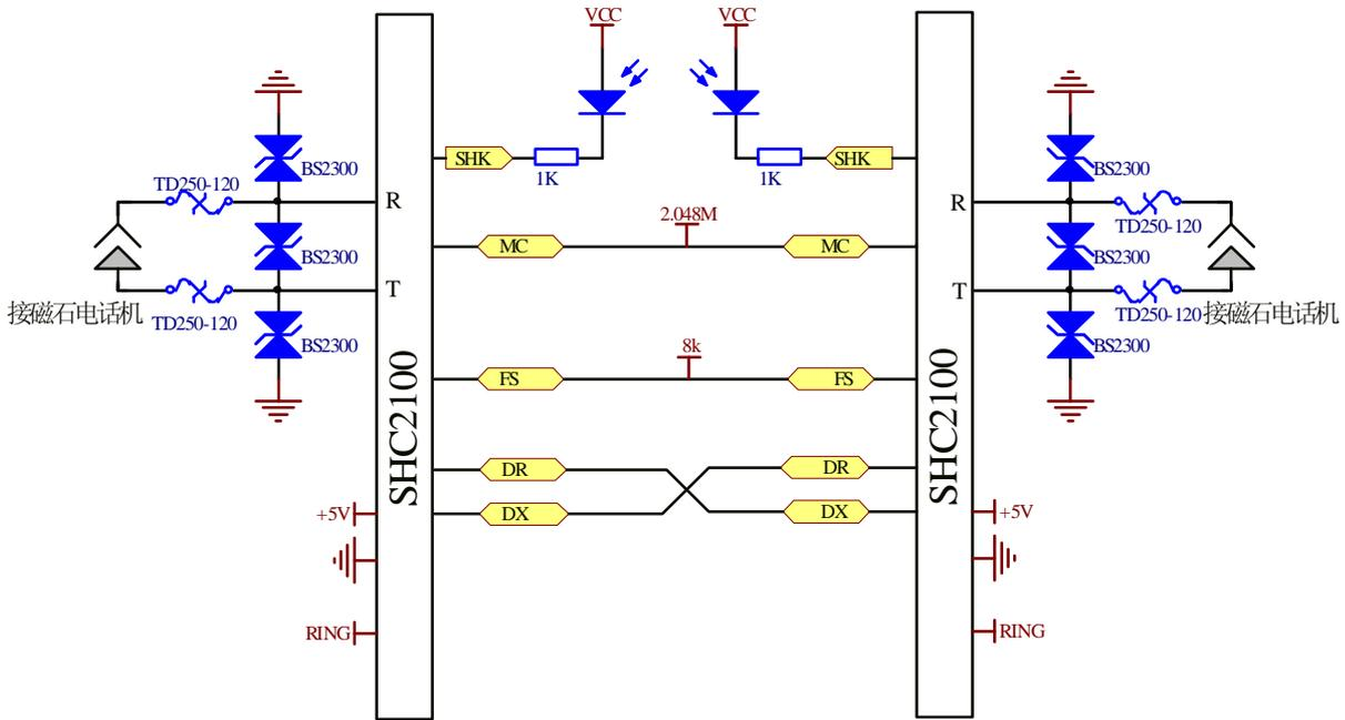
注：图中保护方案，已通过 1500V 差模和 4000V 共模雷击测试。
